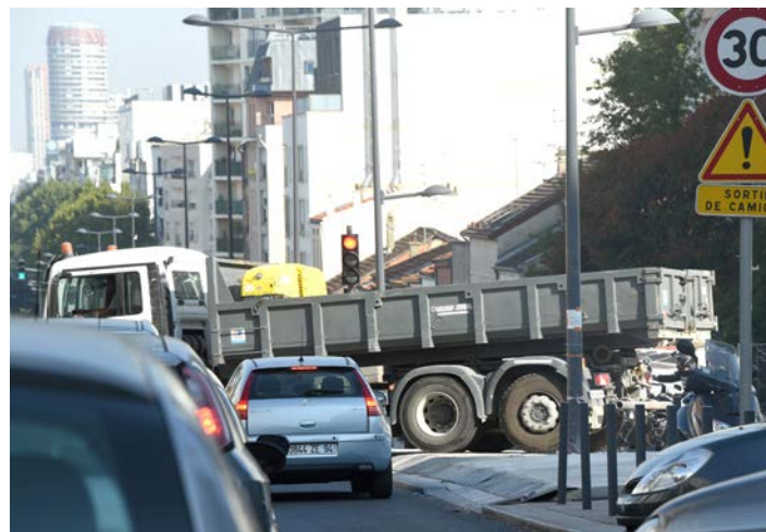
Les camions doivent impérativement rentrer en marche avant. Ici, le chauffeur ne respecte pas les règles, ce qui occasionne un blocage de la circulation. En outre, il peut heurter un cycliste ou un piéton en reculant.
